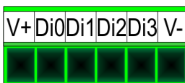
Slika 10. Spoljni konektor CM digitalnog ulaznog modula
