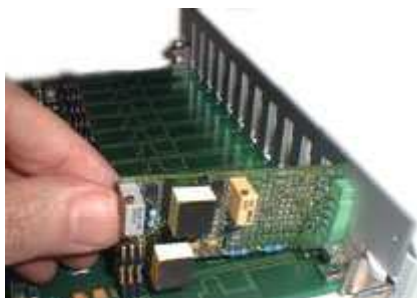
Slika 3. Montaža CM modula na DA akviziciju
