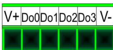
Slika 11. Spoljni konektor digitalnog izlaznog modula
