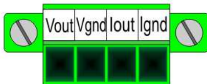
Slika 6. Spoljni konektor CM analognog izlaznog modula
