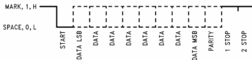
Slika 3. Format prenosa podataka serijskom vezom
